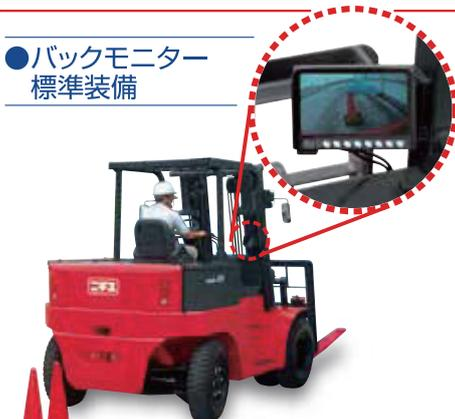
走行時や荷役作業時、車体後方の視界を確保。今まで死角であった車体後方下部を運転席モニターで確認できます。後進時に積荷を傷付けたり、作業車と接触しそうな「ヒヤリ・ハット」をなくします。
