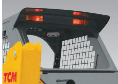
後部コンビネーションランプをヘッドガード上部へ移設することで、視認性の向上と接触によるランプ破損防止を図りました。
