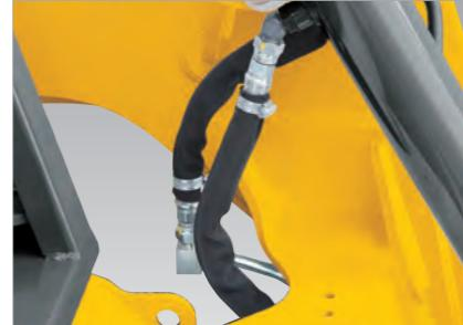
バケットシリングホースに保護材を追加し、ホース破損による油漏れからオペレーターを保護します。
