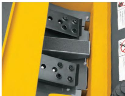
油圧パイロット式の操作システム採用により、ペダル操作力低減を図り、オペレーターの疲労を軽減します。
