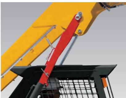
ブームを上げた状態で固定するためのブームストッパーを新設。点検作業を安全に行えます。
