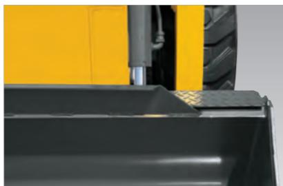
パケットシリンダーへの荷こぼれがかかりにくい位置へレイアウト変更に加え、キャップシール構造を改良することで、異物混入による油圧回路を保護し、信頼性を向上しました。
