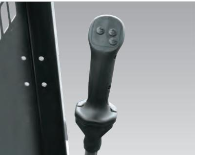
ワインカーボタン式に、アタッチメントハンドコントロール(オプション)をシーソースイッチに変更し、操作性を改善しました。また、エンジン取付方法の改良により、走行レバーに伝わる振動を従来車に比べて約1/4に低減し、オペレーターの疲労低減を実現しています。
