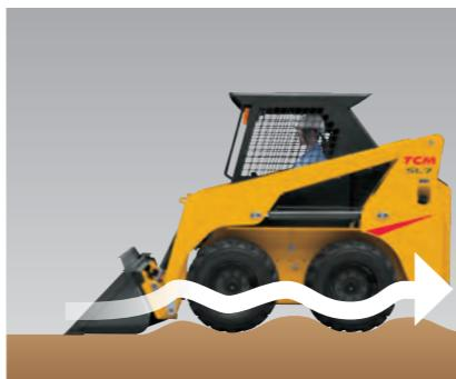
荷役フロートスイッチを押しながらブームを下降させると、ペダル操作をしなくてもバケットが路面の凹凸に対して自由に動き、地ならしや牛舎の清掃などの作業を容易化する機能を装備しています。
