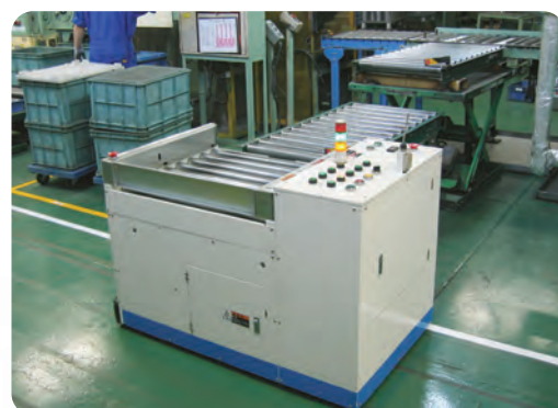
・生産ラインで工程間搬送(ローラーコンベヤ方式)
