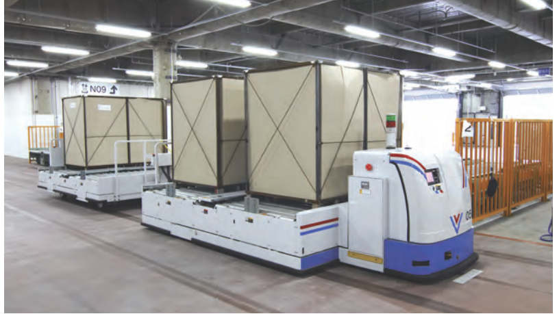
・台車をけん引し、一度に大量の荷物を搬送する「ムジンカー」(けん引型)
