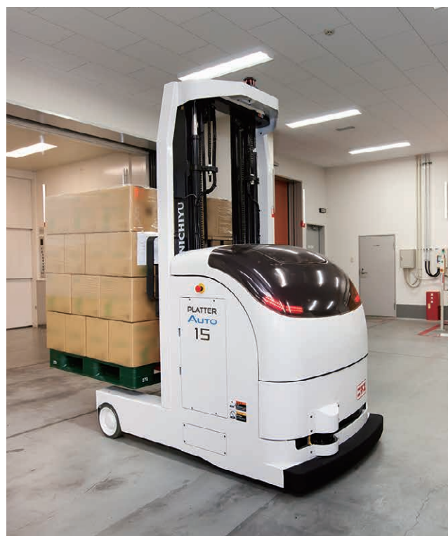
・床面工事が不要の「レーザー誘導方式 プラッターオート」
