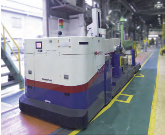
・最大10tの鉄鋼原料を溶解炉へと搬送する「ムジンカー」(荷台傾斜式)
