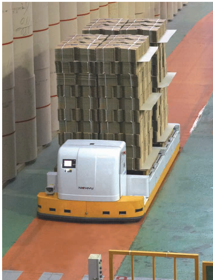
・段ボール生産工場で製品を搬送する「ムジンカー」(低床型)
